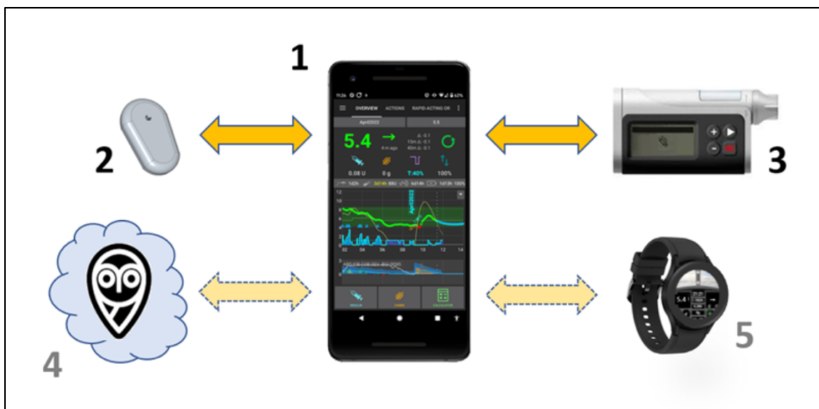
Figure 92 : Description du système APS d'Android (Artificial Pancréas System), AAPS[105] (1) Android smartphone (2) CGM (3) la pompe à insuline (4) Nightscout (5) smartwatch.
