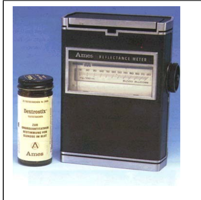
Figure 53 : Glucometer 1, mesure la glycémie par réflectance-métrie avec les bandelettes Dextrostix.
