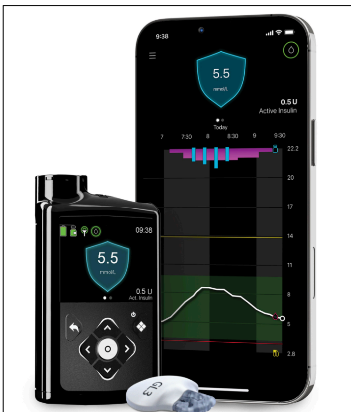
Figure 68 : Illustration d'un système en boucle fermée propriétaire : la MiniMed 780G (Medtronic), composé de la pompe à insuline, du capteur Guardian Link 3 (GL3) et de l'application MiniMed Mobile.
