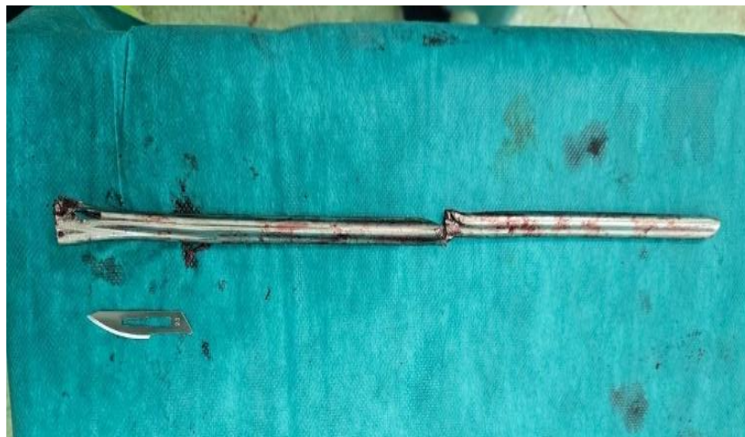
Figure 31 : Un clou centro-médullaire rompu explanté
