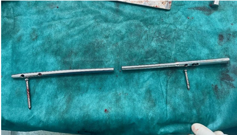
Figure 32 : Un clou centromédullaire rompu explanté avec vis de verrouillage proximal et distal
