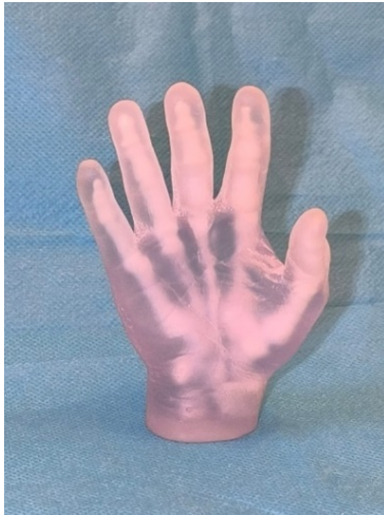
Figure 103 : Modèle anatomique de main imprimée en résine transparente avec l'imprimante Projet MJP 2500.
