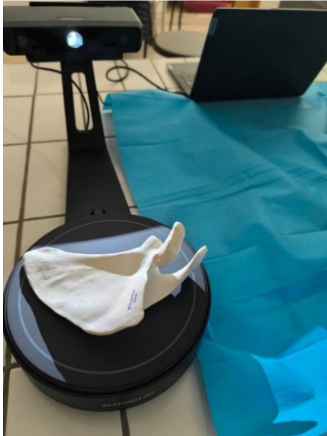
Figure 93 : Image illustrant l'acquisition numérique du modèle de scapula à l'aide du scanner Shining 3D EinScan-SE V2.
