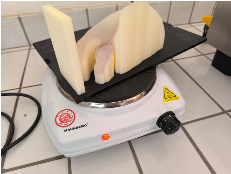
Figure 49 : Image illustrant l'utilisation de la plaque chauffante pour faciliter le décollage de la pièce imprimée du plateau.
