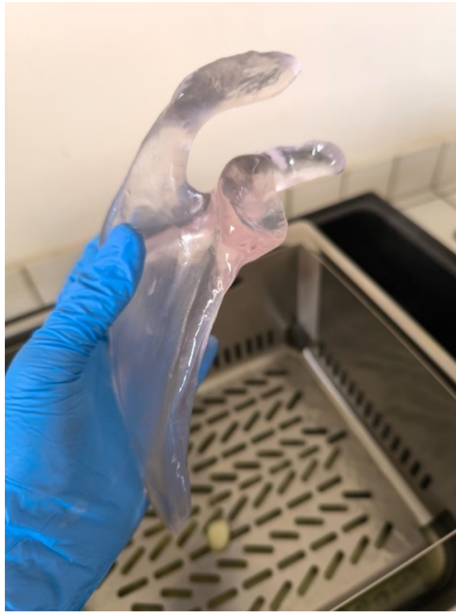
Figure 51 : Pièce imprimée après nettoyage dans le système Easyclean.
