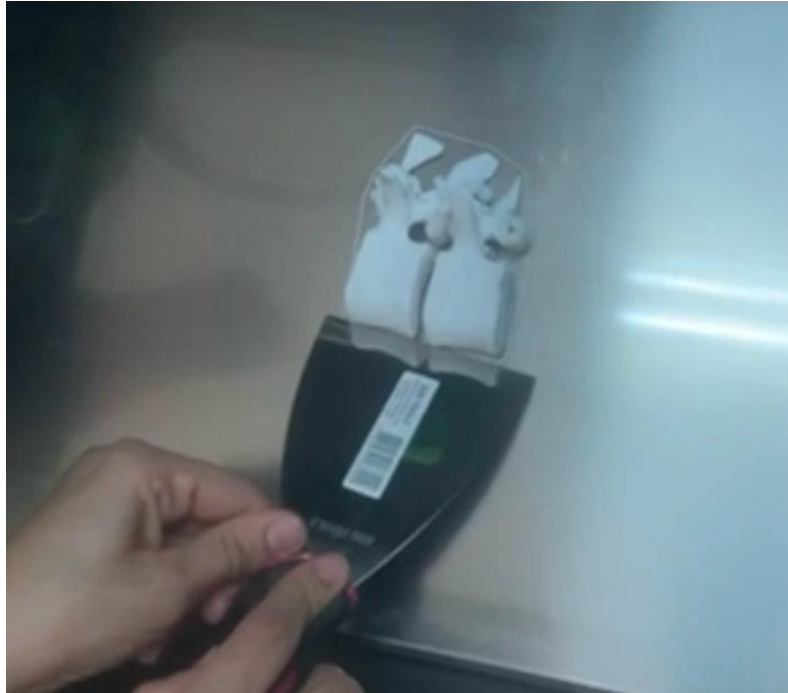
Figure 45 : Décollement de la pièce du plateau d'impression.
