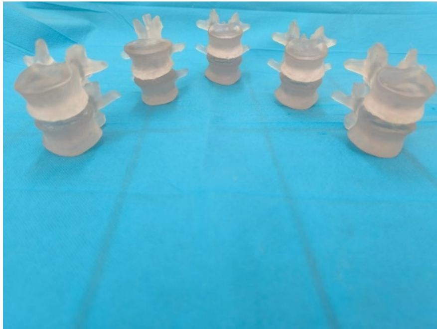
Figure 91 : Les modèles anatomiques de vertèbres après impression et post-traitement.
