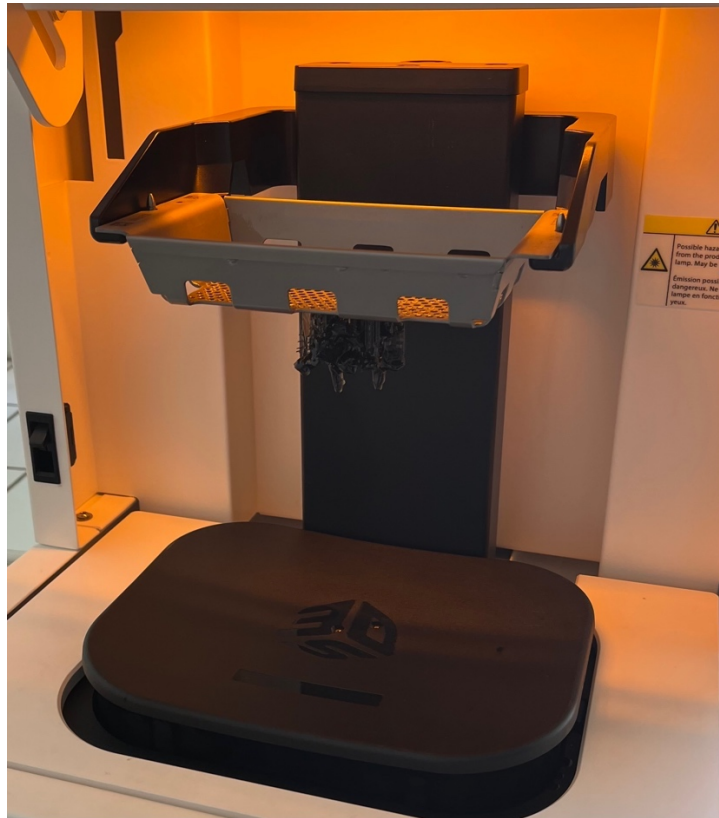
Figure 61: Image de la pièce collée au plateau d'impression.
