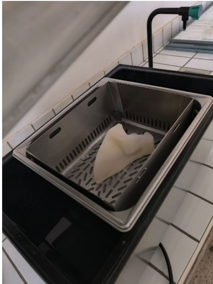
Figure 50 : Le système Easyclean avec la pièce imprimée couverte de cire.
