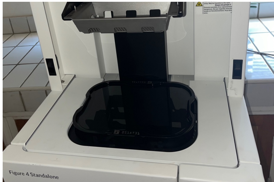
Figure 58 : Image du bac à résine de l'imprimante Figure 4 standalone.
