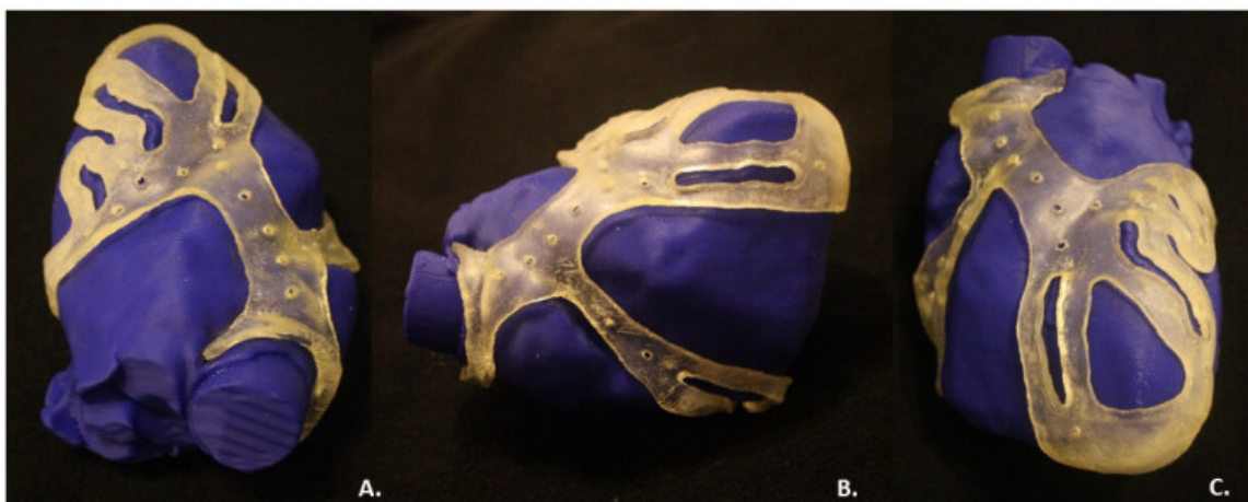
Figure 29 : Test d'ajustement du guide chirurgical sur le cœur fantôme : (A) Vue supérieure ; (B) Vue latérale droite ; (C) Vue frontale, reproduit de (78), sous licence Creative Commons Attribution 4.0 International (CC BY 4.0), https://creativecommons.org/licenses/by/4.0/ .
