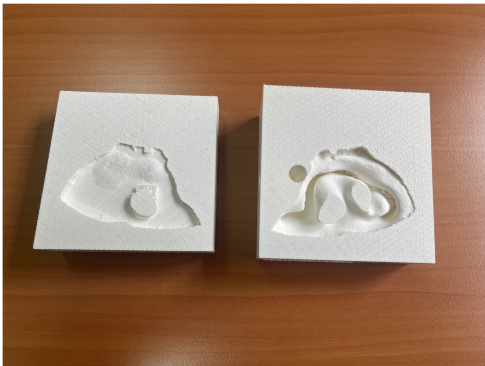
Figure 89 : Les deux moitiés du moule après impression et post-traitement.
