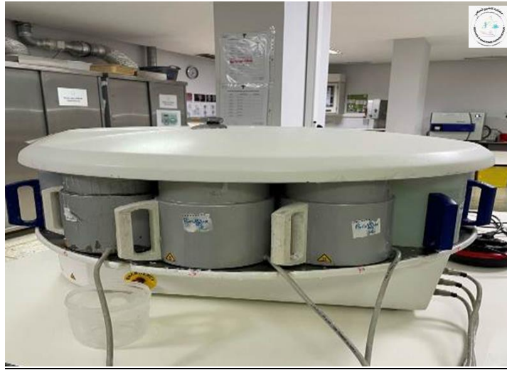
Figure 1 : Automate d'inclusion en paraffine pour la préparation d'échantillons en anatomopathologie au sein du service d'anatomie pathologique du CHU Mohamed VI de Marrakech
