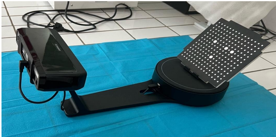
Figure 3 : Einscan SE V2 Shining 3D utilisé au laboratoire d'anatomie de la faculté de médecine et de pharmacie de Marrakech.
