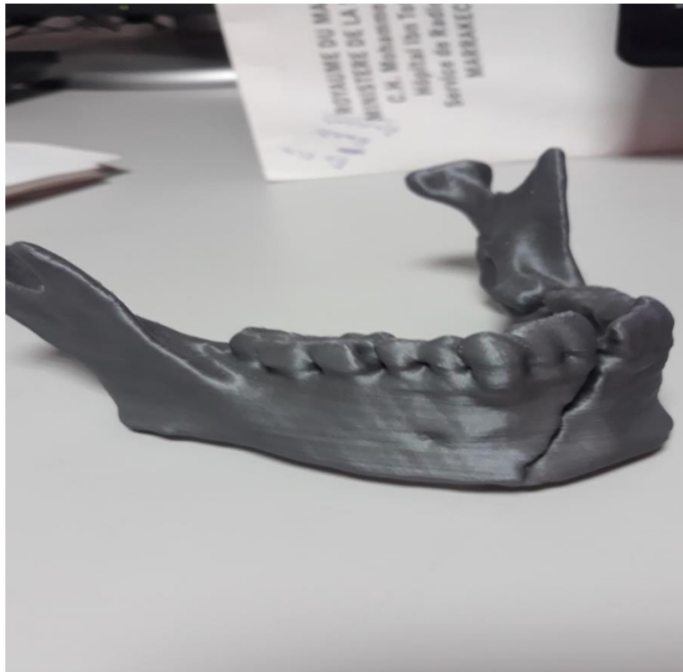
Figure 23 : Impression 3D du modèle anatomique mandibulaire issue de la modélisation numérique du traumatisme mandibulaire.
