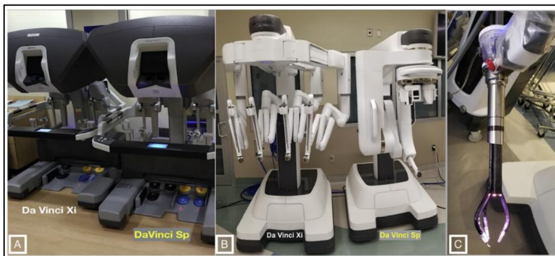
Figure 56. (A) Comparaison des consoles Da Vinci Xi et SP, (B) Comparaison des robots Da Vinci Xi et SP, (C) Les instruments de Da Vinci SP. [133]
