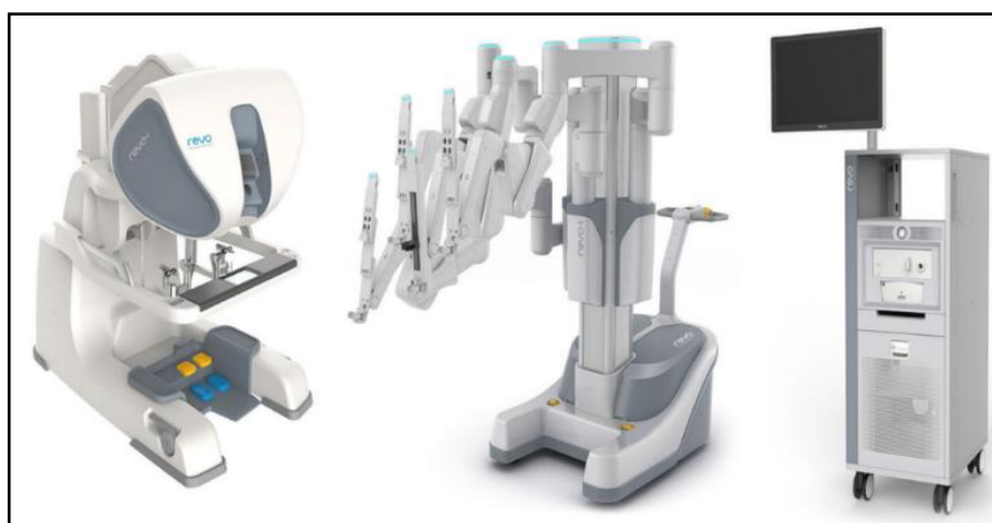
Figure 63. Les composants du robot chirurgicale Revo-i. [144]
