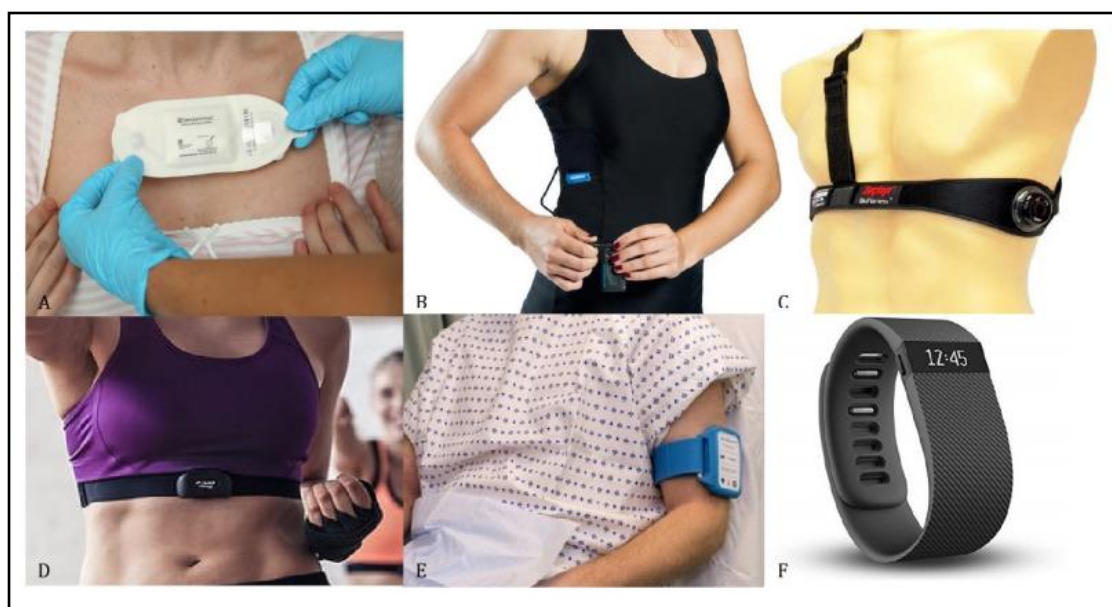
Figure 88. Exemples de dispositifs de surveillance à distance. [188]
