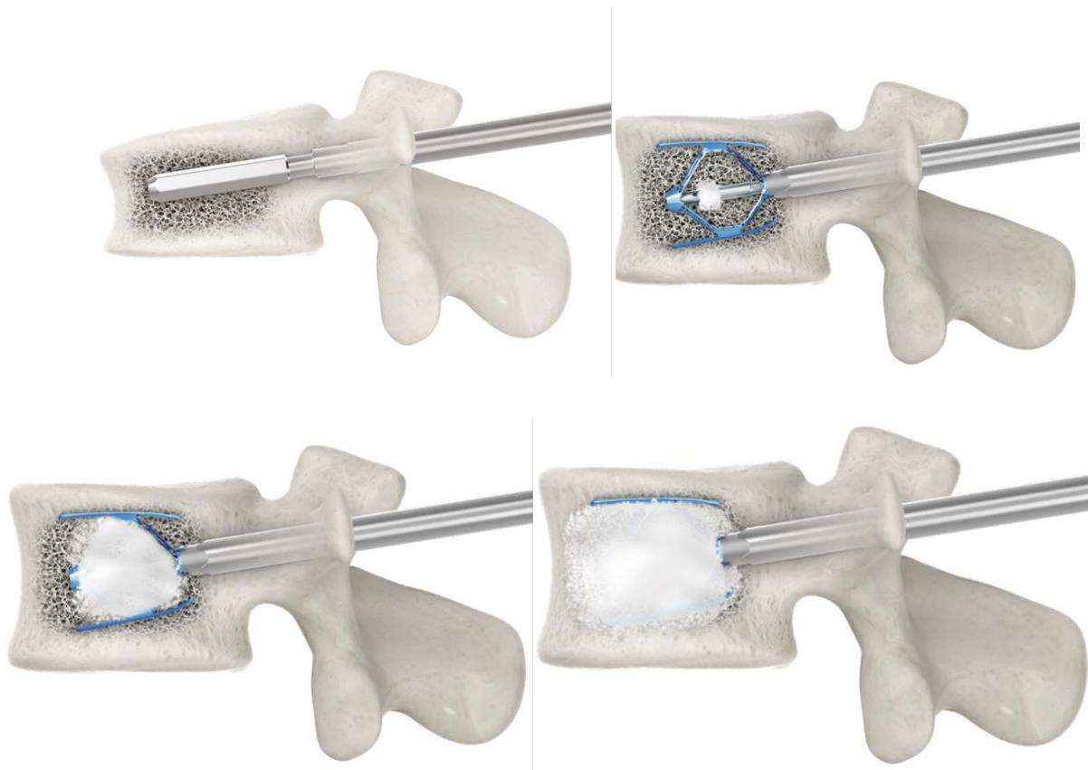
Figure 74 : Principe de fonctionnement de l'implant SpineJack®
