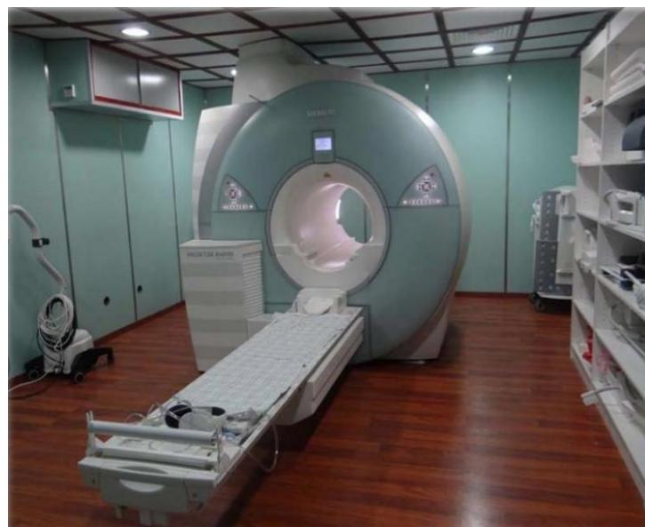
**Figure 1: Appareil IRM Siemens 1,5 Tesla.**
