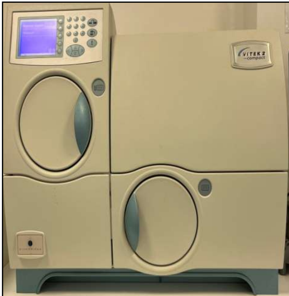
Figure 13 : Automate Vitek 2 compact pour l'identification des levures et la réalisation d'antifongigramme. Photo prise au laboratoire de Parasitologie Mycologie de l'HMA de Marrakech.
