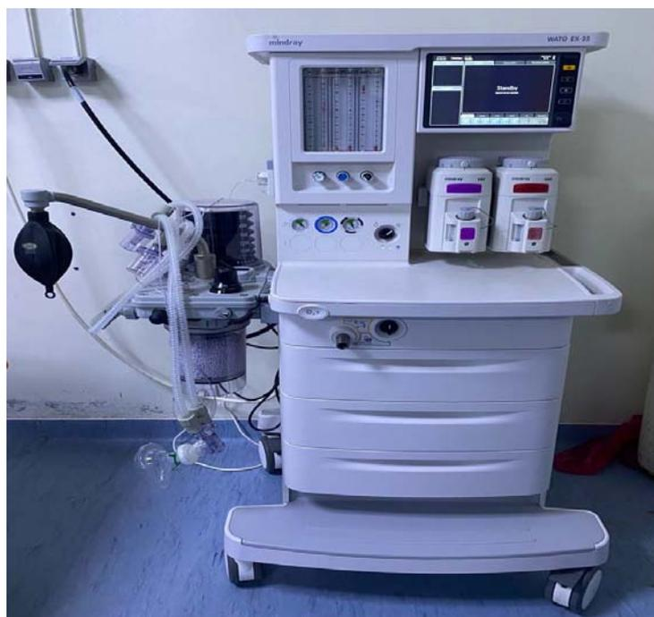
**Figure 16 : Appareil d'anesthésie avec vaporisateur des halogénés**
