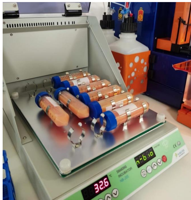
Figure 16: Mise en place des flacons contenant le TA lavé et la collagénase en incubation à 37°C et agitation constante.
