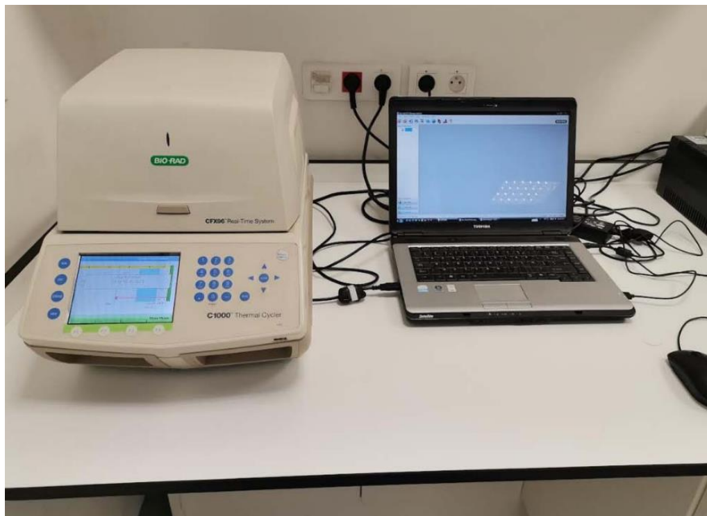
Figure 16: à gauche automate d'amplification a droite ordinateur comportant le logiciel d'interprétation
