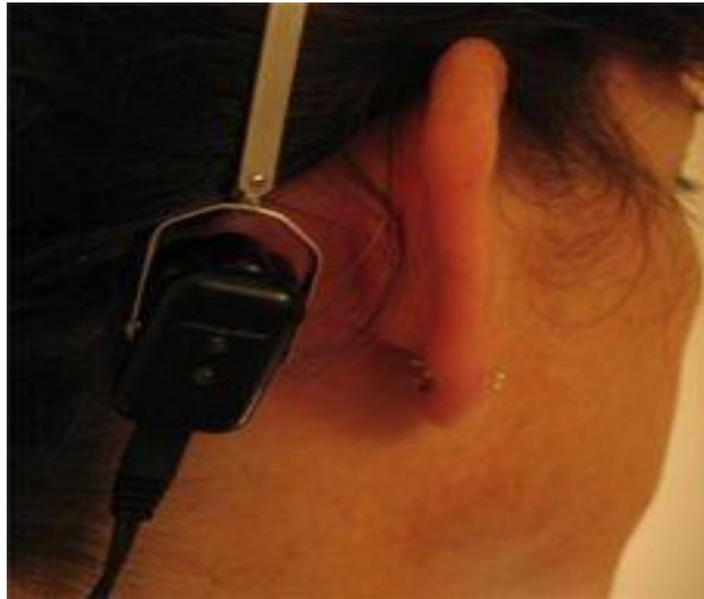
**Figure 20 : Serre-tête pour l'examen de conduction osseuse [26]**
