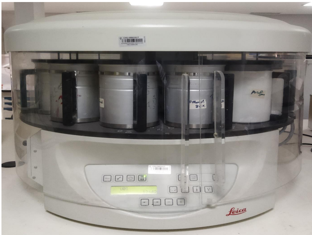
Figure 71 A : L'appareil d'inclusion automatique des cassettes. Laboratoire d'anatomie pathologique, CHU Mohamed VI de Marrakech
