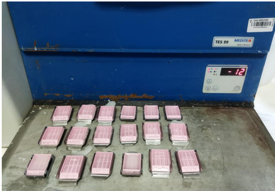
Figure 73 : Refroidissement des prélèvements sur une plaque de refroidissement. Laboratoire d'anatomie pathologique, CHU Mohamed VI de Marrakech
