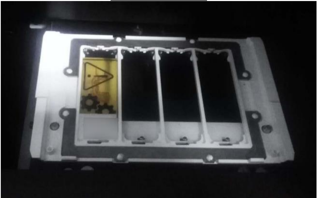
Figure32 : Chariot où on met les lames à numériser dans le scanner Leica SCN400 disponible au service d'anatomie pathologique du CHU Mohammed VI de Marrakech
