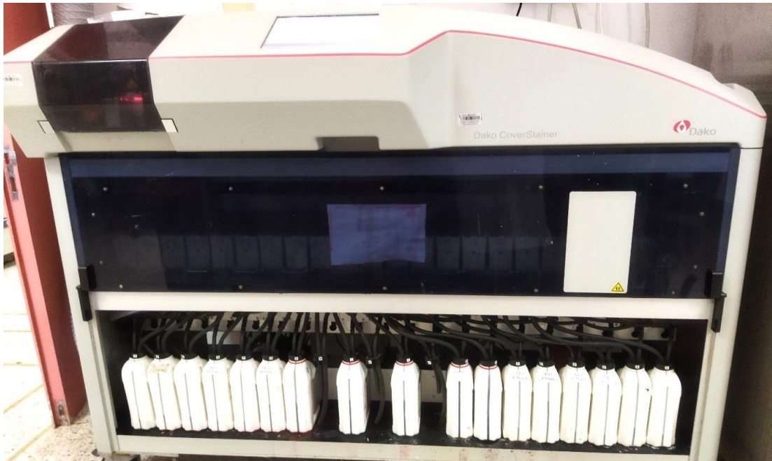
Figure 80: Appareil de coloration automatique. Laboratoire d'anatomie pathologique, CHU Mohamed VI de Marrakech
