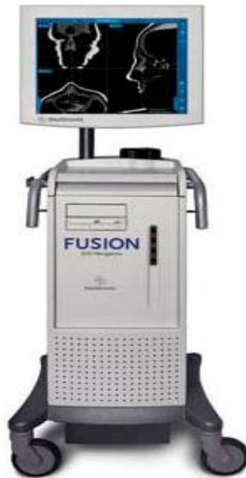
Figure 39: Station de NAO équipée d'un système électromagnétique : le référentiel spatial résulte de la création d'un champ électromagnétique englobant la zone opératoire, dans lequel la position d'un instrument couplé à un support électromagnétique va pouvoir être déterminée.
