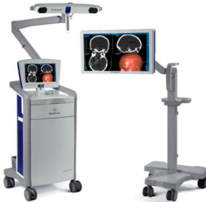
Figure 38 : Station de NAO équipée d'un système optique : le référentiel spatial résulte d'une batterie de trois caméras infrarouges qui déterminent la position d'un instrument muni d'émetteurs infrarouges ou de capteurs réfléchissant les infrarouges.
