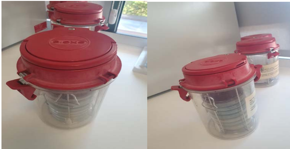
Figure 4 : Jarre à anaérobie, service de microbiologie HMA, Marrakech
