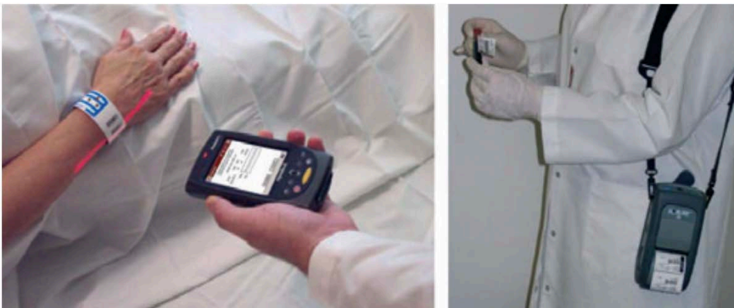
Figure 33 : Un système à code-barres pour l'étiquetage des échantillons de sang au chevet du patient [62]
