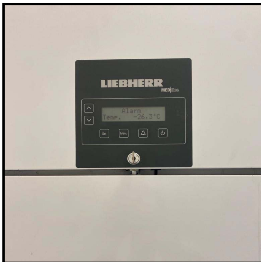
Figure 36 : Réglage du congélateur de plasma : température et alarme : -25 à -30 °C (équipement du service de TS de l'hôpital militaire à Marrakech).
