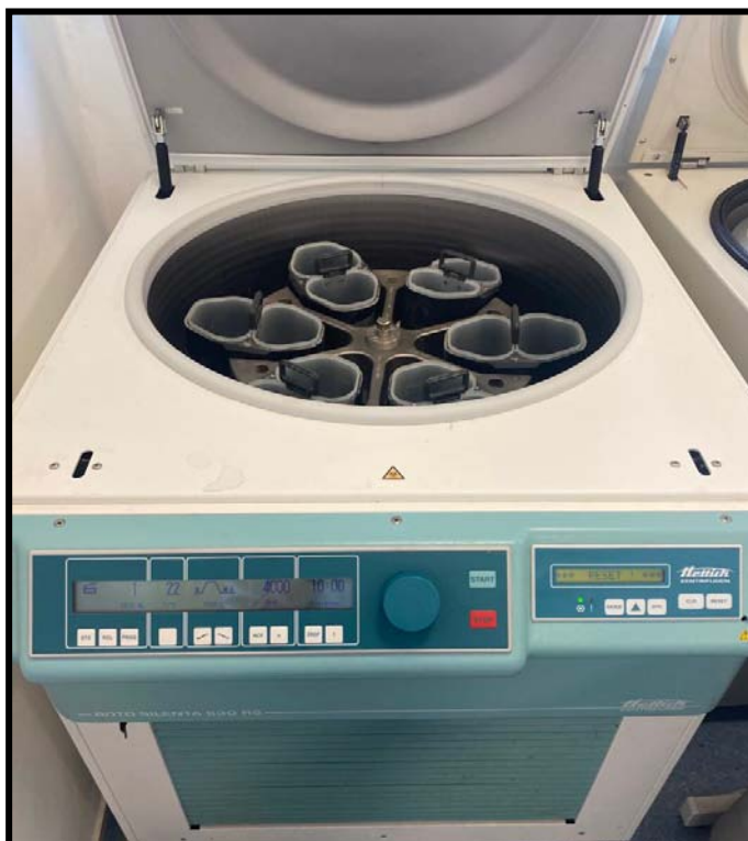
Figure 14: Centrifugeusedes poches du sang total (12 poches) du service de TS de l'hôpital militaire à Marrakech.
