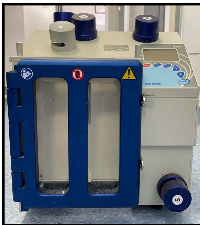
Figure 23 : Presse à plasma semi automatique au service de TS de l'hôpital militaire à Marrakech.
