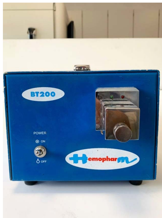
Figure 93 : Soudeuse (scelleuse des tubulures) unique fixe, de la marque Hemopharm. (Service de TS, HMA, Marrakech)
