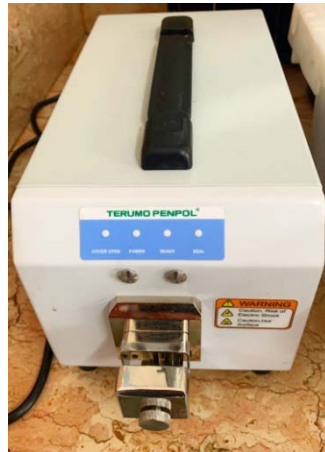
Figure 94 : Soudeuse (scelleuse des tubulures) unique fixe, de la marque Terumo. (CRTS d'Agadir)
