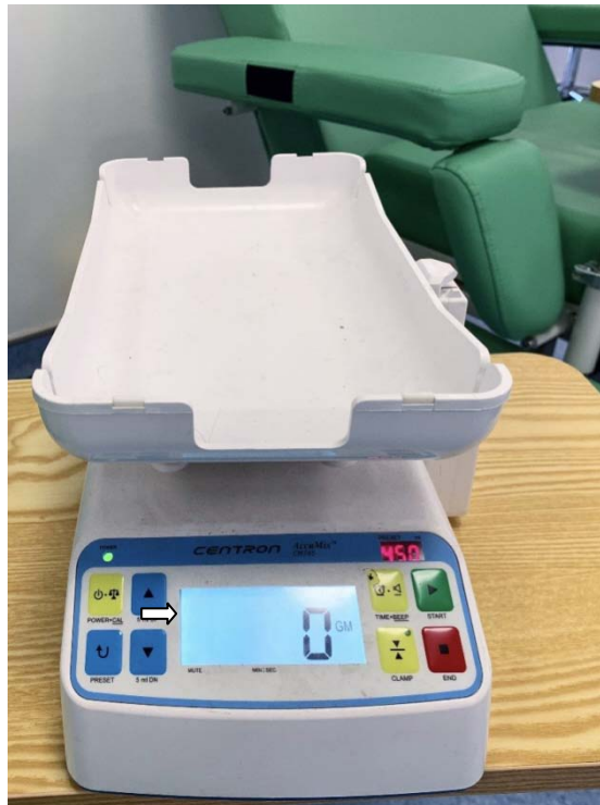
Figure 99 : Agitateur de la poche du sang Total lors du prélèvement du donneur, marque Centron avec un afficheur de poids (flèche blanche). (Service de TS, HMA, Marrakech)
