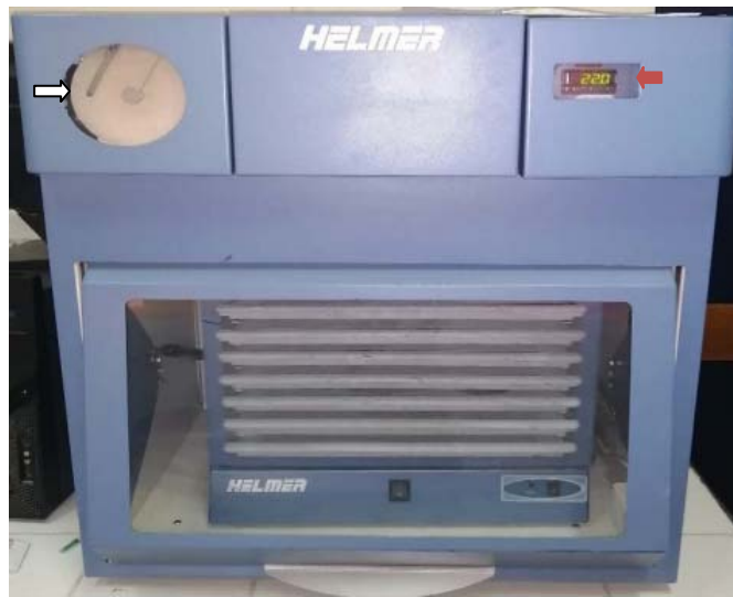
Figure 97: Agitateur de plaquettes de la marque Helmer, conservant les plaquettes à +22°C avec un afficheur de température (flèche rouge) et enregistreur de température ( flèche blanche).
