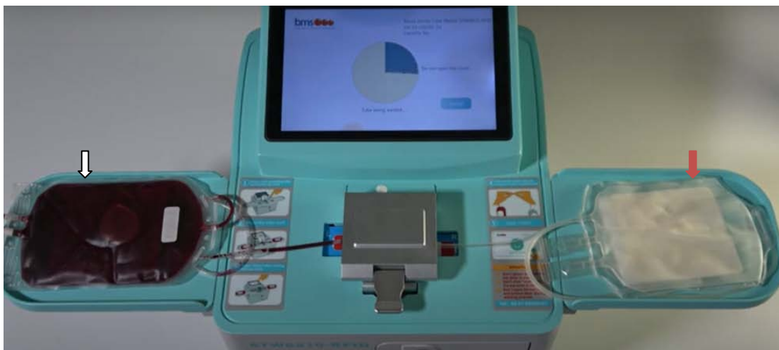
Figure 95 : Dispositif de connexion stérile, connectant de façon stérile une poche de sang (flèche blanche) et une poche satellite (flèche rouge) .
