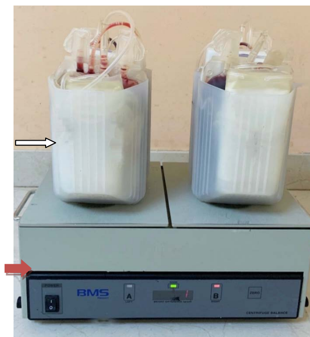
Figure 90: Balance électronique BMS (Flèche rouge), avec deux plateaux de pesée pesant les pots de centrifugeuses (flèche blanche) contenant les poches de sang total pour centrifugation primaire. (CRTS de Marrakech)
