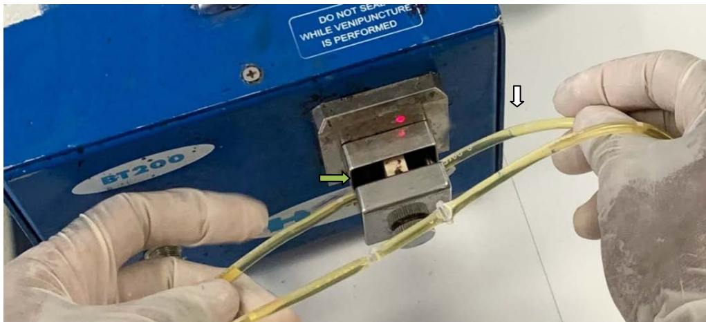
Figure 126 : Membre du personnel scellant les tubulures des poches (flèche verte) conformément aux exigences. (Flèche blanche : Tubulure) (Service de TS, HMA, Marrakech)
