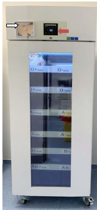
Figure 96: Réfrigérateur pour stockage des CGR, à température de +4°C (flèche rouge), avec un enregistreur de température (flèche blanche), à une capacité de 600L, marque Liebherr. (Service de TS, HMA, Marrakech)
