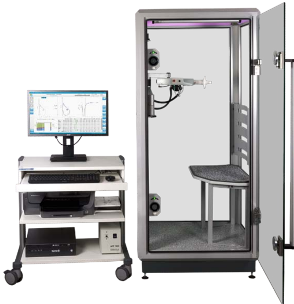
Figure1 : pléthysmographe corporel GANSHORN actuel connecté au logiciel LFX pour exposition des résultats utilisé pour le dépistage de la BPCO chez les patients de notre étude
