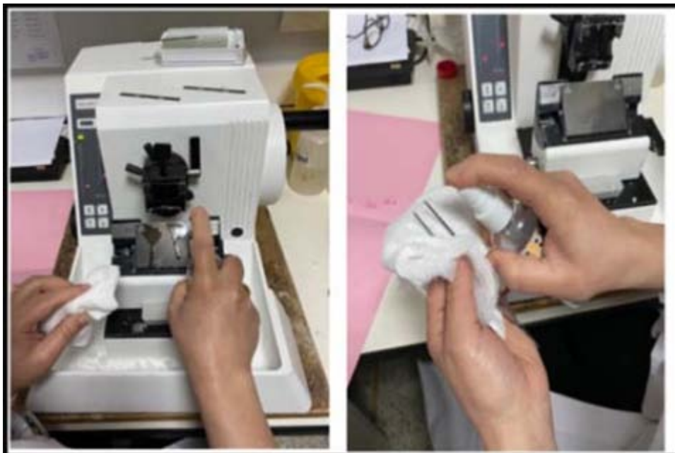
Figure 3 : Essuyage du microtome et de la pince par DNA lytique, décontamination Au Service d'anatomie pathologique CHU Mohammed VI Marrakech
