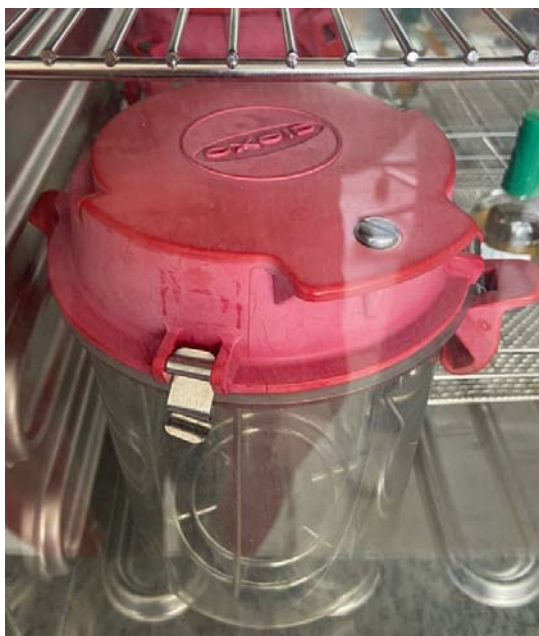
Figure 3 : Jarre à anaérobiose. Service de microbiologie HIT, Marrakech
