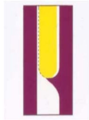
Figure23 : un piedestal situé au dessous d'une extrémité instable suggère l'instabilité [52]
