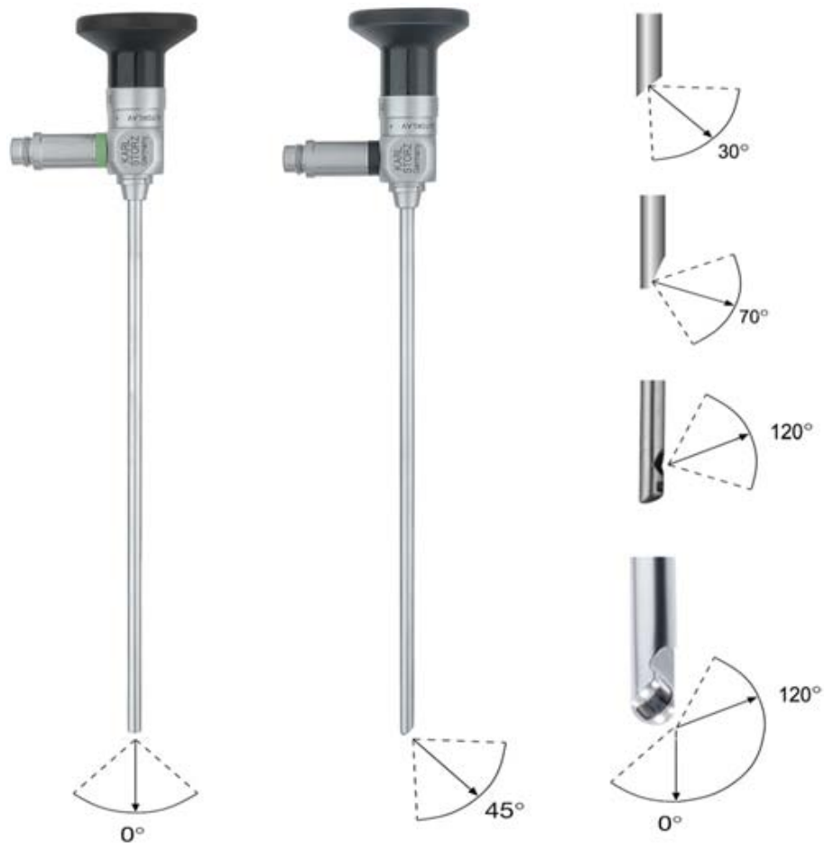
Figure 14 : Endoscopes de Hopkins (Storz), la zone de vision, et différents angles de vision : 0 degrés, vue directe ; 30-45 degrés, avant-obliques ; 70 degrés, latérales ; 120 degrés, rétrogrades ; 0-120°, réglage variable [10].
