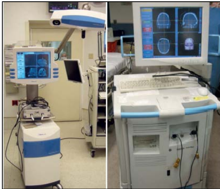
Figure 31: Deux stations de Neuronavigation, provenant de deux fabricants différents, couplées d'une station de travail informatique, un système de suivi, une interface informatique et un affichage d'image [192].
