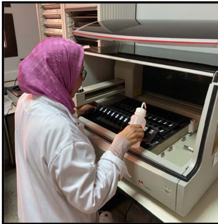
Figure 6: Appareil d'immunohistochimie Autostainer Link48 de Dako. Service d'anatomie pathologique du CHU Mohammed VI, Marrakech
