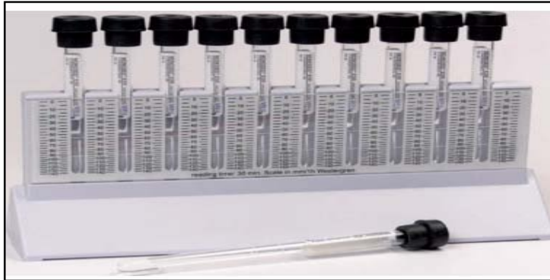
Figure 1 : Système pour la détermination de la vitesse de sédimentation. Photo prise au laboratoire d'hématologie de l'HMA.
