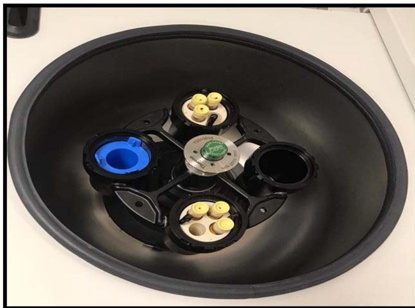
Figure 26 : Centrifugation de six tubes de sang pendant 20 à 30 min pour isoler le plasma riche en plaquettes.
