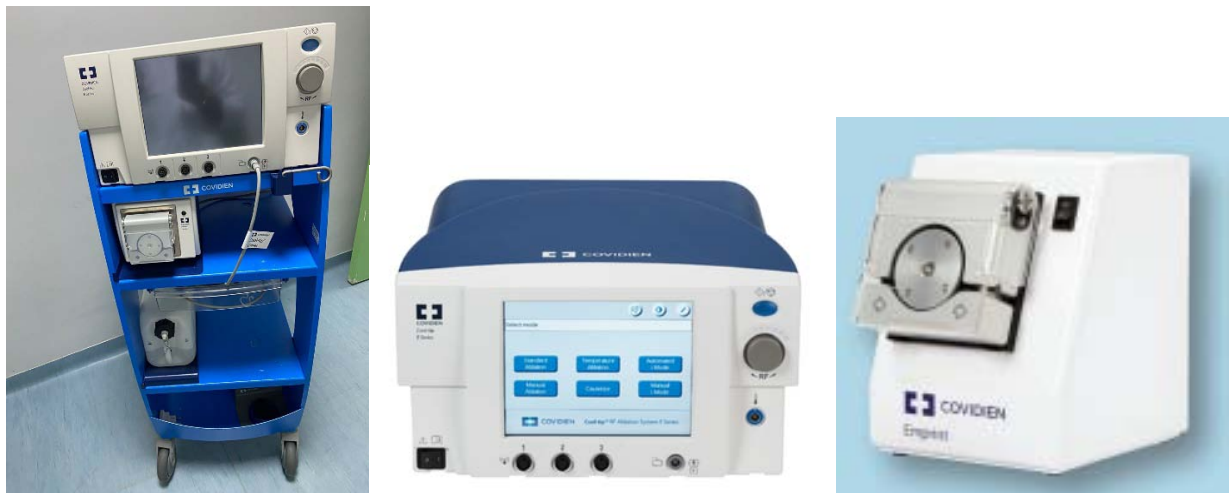
Figure 1 : a) Système de radiofréquence (COVIDIEN cool-tip E séries ) (Medtronic) sur chariot avec les différents composants : a) Générateur ; b) Une pompe pour refroidir les antennes efficacement et minimiser la conductivité thermique pour plus de contrôle et de prévisibilité.
