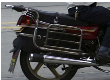
Figure 45 : photo illustrant une moto avec une double protection métallique [26]
