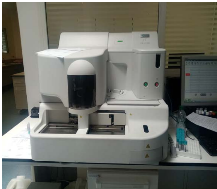
Figure 2: Automate Sysmex CS-2000i utilisé pour effectuer le bilan d'hémostase dans le laboratoire d'hématologie HMA
