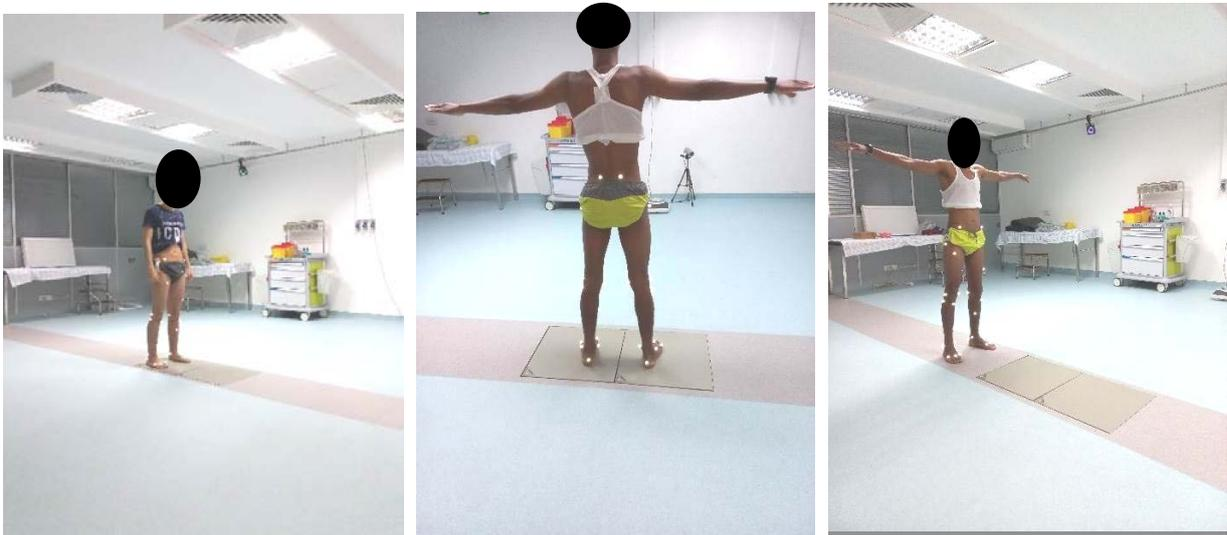
**Figure 36** : Images représentant l'enregistrement statique des marqueurs et permettant de calculer les positions de ses centres articulaires
