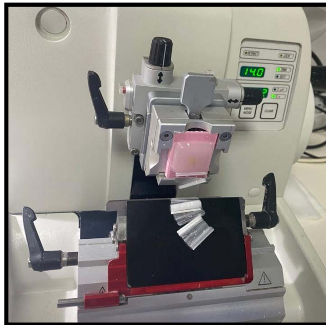
Figure 7 : Après enrobage en paraffine, les tissus sont coupés grâce à un microtome automatique, service d'anatomie pathologique CHU Mohammed VI Marrakech
