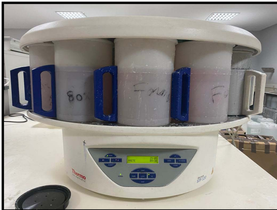
Figure 5: Automate circulateur utilisé pour la déshydratation des prélèvements. Service d'anatomie pathologique. CHU Mohammed VI de Marrakech
