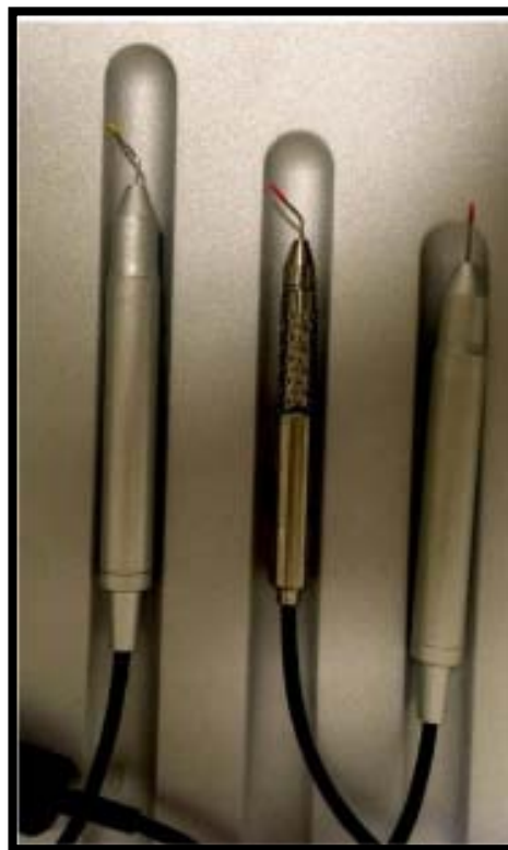
Figure 5: les instruments du simulateur Eyesi, avec de gauche à droite la sonde d'irrigation aspiration, la pince à capsulorhéxis et la pince à main.
