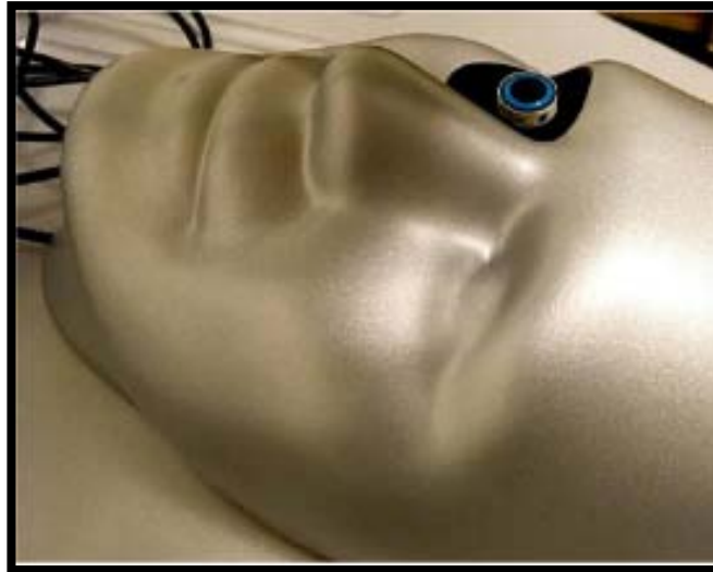
Figure 4: tête de simulateur Eyesi, permettant de réaliser la chirurgie en supérieur ou en temporal.
