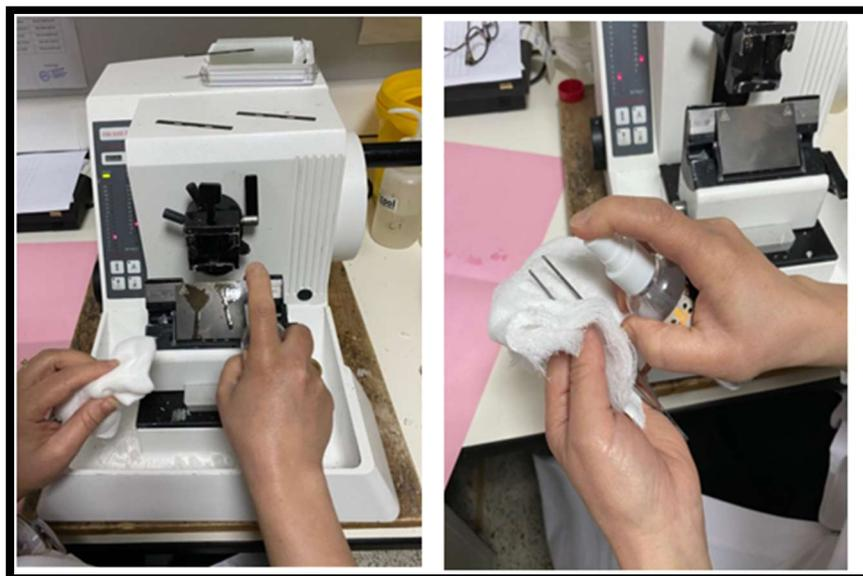
**Figure 3: Essuyage du microtome et de la pince par DNA lytique, service d'anatomie pathologique CHU Mohammed VI Marrakech**
