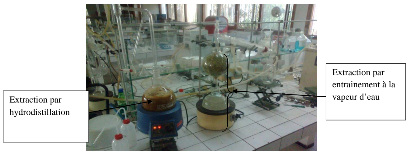
Fig. 8 : Extraction des HE [Photo du laboratoire de Génie des procédés et Biotechnologie végétale de la faculté des Sciences Ibn Zohr d'Agadir]
