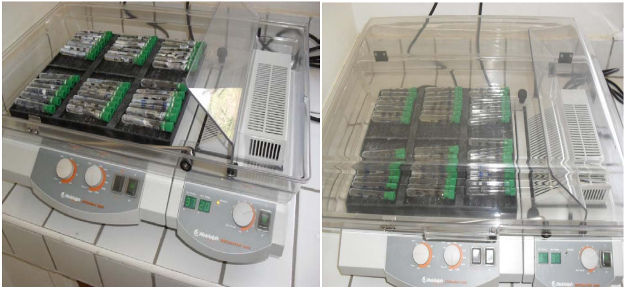
Fig. 14: Incubation des tubes pendant 48 heures à 37°C sous agitation continue [Photo du laboratoire d'immunologie de la faculté de médecine et de pharmacie de Marrakech].
